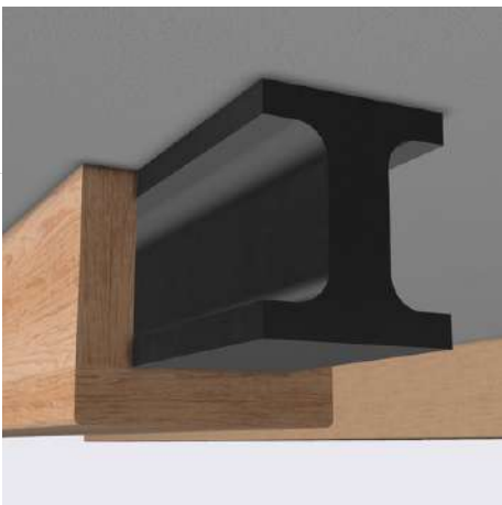
Tapar vigas metálicas a la vista
