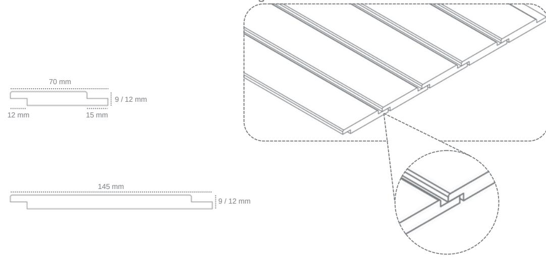
\* Para solución Flek y Flek S : Fijar sobre subestructura con distanciamiento de 400 mm entre apoyos.
