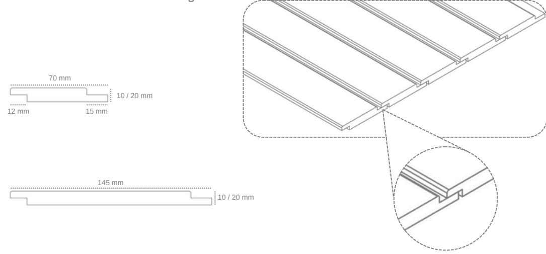
\* Para solución Revo y Revo S : Fijar sobre subestructura con distanciamiento máximo de 400 mm entre apoyos.
